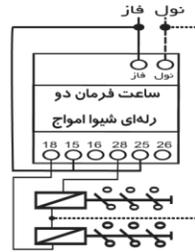
توجه! از وصل کردن مستقیم بارهای خازنی یا سونچینگ یا درایورهای LED به دستگاه به دلیل جریان بیش از حد راه اندازی در این نوع مصرف کننده ها ، خودداری گردد. در این موارد الزاماً از رله خارجی یا کنتاکتور مناسب استفاده گردد.
